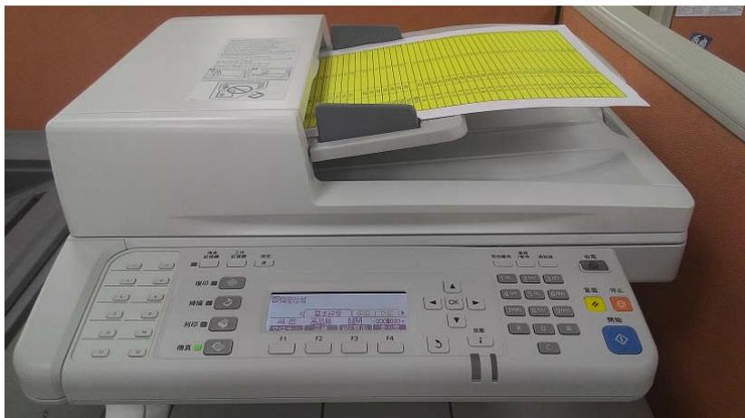
2-2：在液晶面板的左側，按下「掃描」功能鍵，此時「掃描」功能燈會亮起，液晶面板顯示：指定掃描位址時，按下方「F3」鍵，選擇「電子郵件」。
